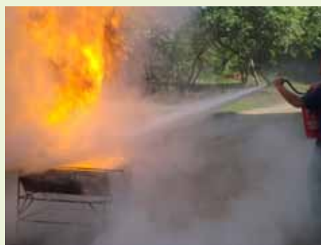
Figura 48 Extinção por abafamento
